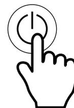
Appuyez sur le bouton marche/arrêt pendant 2 secondes pour mettre le système hors tension. Les fonctions de sécurité de l'unité sont toujours actives lors de la mise hors tension du système. Ainsi, la ventilation peut continuer à fonctionner un moment après la sélection du mode Arrêt.
