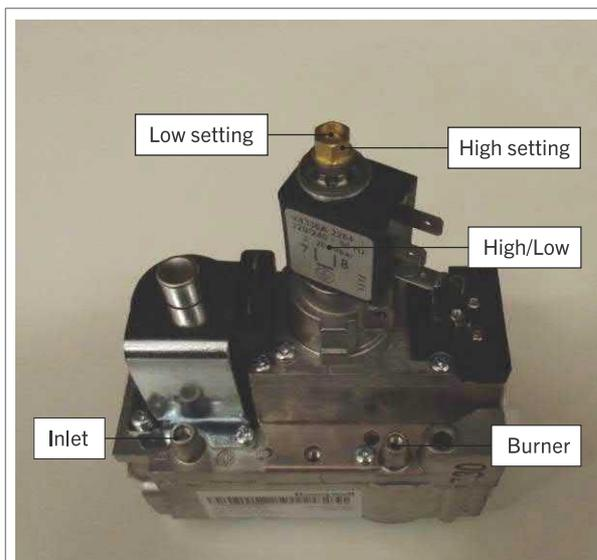
Figure 23 - Composants majeurs des vannes de gaz des aérothermes TR125 et TR150
