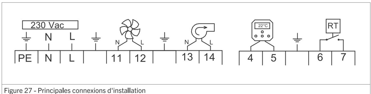
Figure 27 - Principales connexions d'installation
