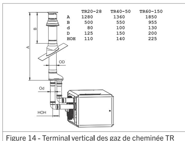
Figure 14 - Terminal vertical des gaz de cheminée TR
