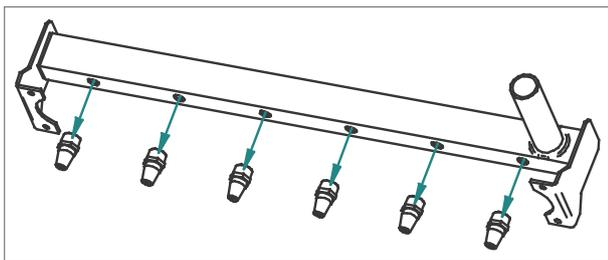
**REMARQUE** Sur les modèles TR125-2 et TR150-2, remplacer l'injecteur Ø 3,5 mm en position supérieure.
