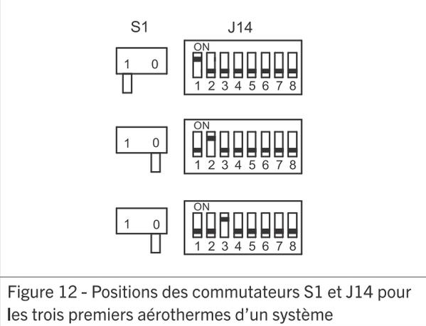
**REMARQUE** Le système ne peut pas fonctionner si le commutateur J14 de plus d'un aérotherme est commuté sur le même numéro.
