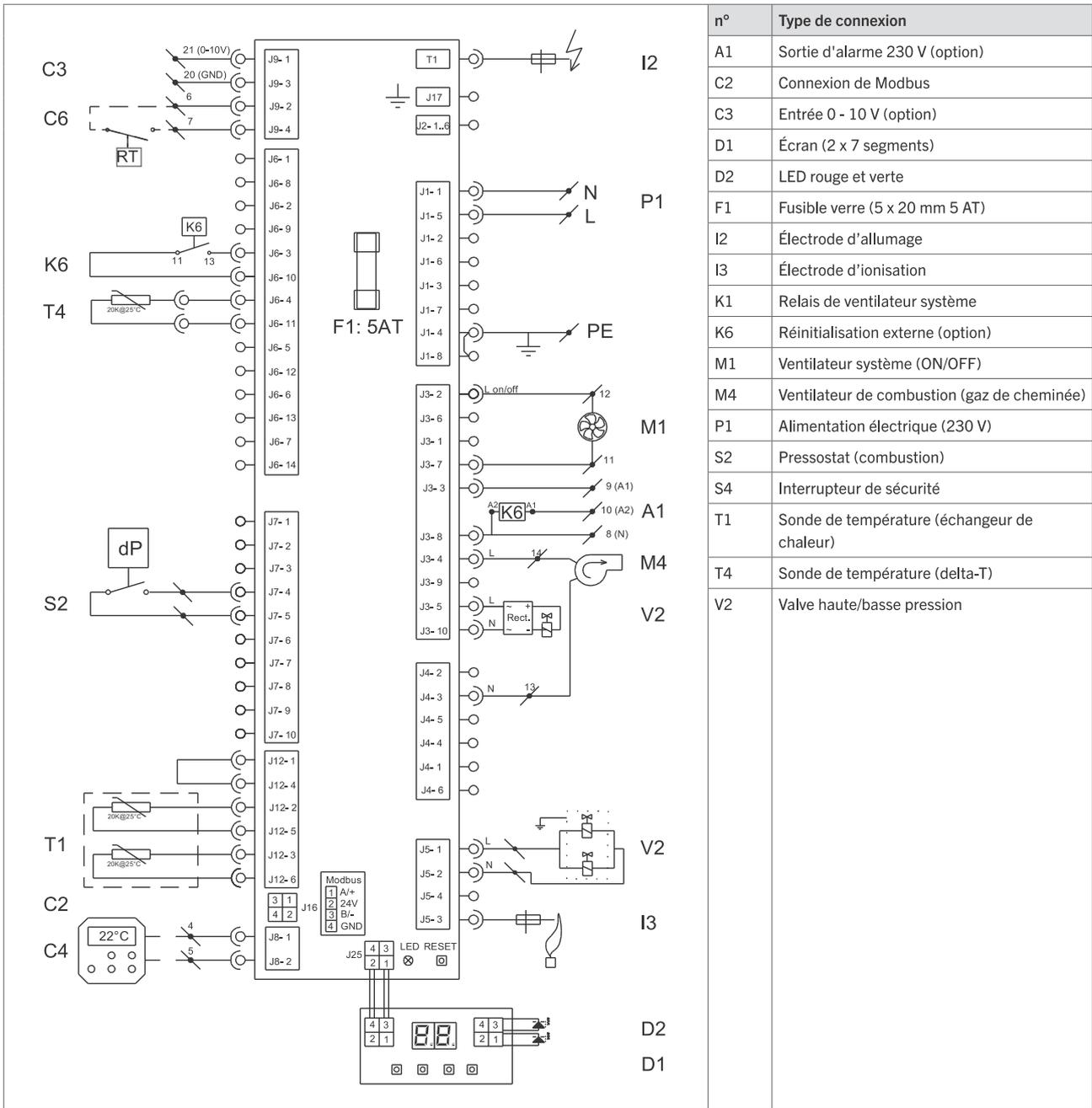
Figure 25 - Schéma de câblage TR10 - 80
