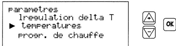
3. Programmer les températures souhaitées entre 0°C et 30 °C. Valider par **OK**.
