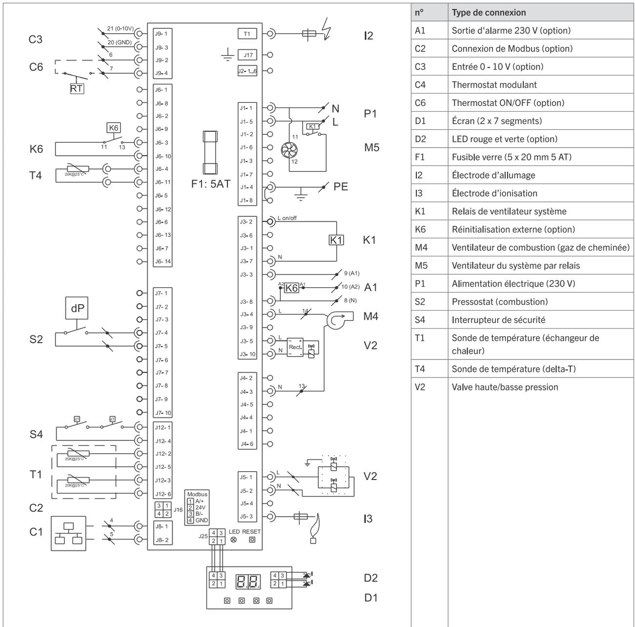
Figure 26 - Schéma de câblage TR100 - 150
