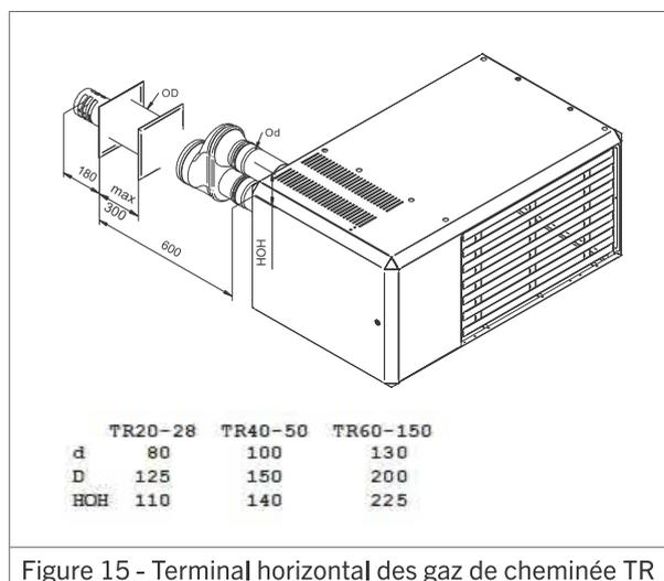
Figure 15 - Terminal horizontal des gaz de cheminée TR
